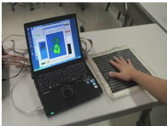
図 9 手のひらでの圧力を加える実験の様子
